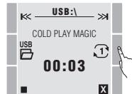
1 Modo repetición de 1 canción. Reproduce la canción seleccionada y la repite infinitamente.
