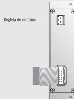
**P1** Regleta de conexión del par telefónico de conexión a la extensión analógica
