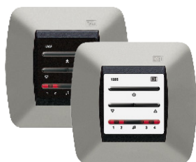
1205.10 / 1205.12 Commande à 4 canaux, auto-amplifiée 1 W, 16 Ω, avec préférence d'annonce.
