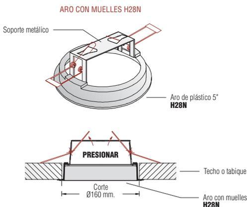
**MONTAJE DE LOS MUELLES SEGÚN EL GROSOR DEL TECHO**
