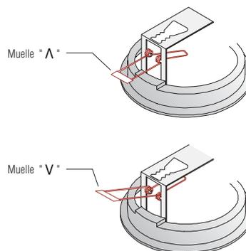
Fijar los muelles en el soporte metálico con el ángulo hacia abajo "Λ" para techos o tabiques delgados de 5 a 35 mm. de espesor.
