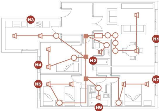
La instalación que se presenta a continuación, está basada en minicentrales, y proporciona 1 programa de audio estéreo, 1 programa de FM, reloj común e intercomunicación\* entre zonas. Si se desea, se puede añadir otro canal de audio en lugar del canal FM, sustituyendo la minicentral 40080 por otra 40070. Está compuesta por elementos básicos de la serie DOMOS2.
