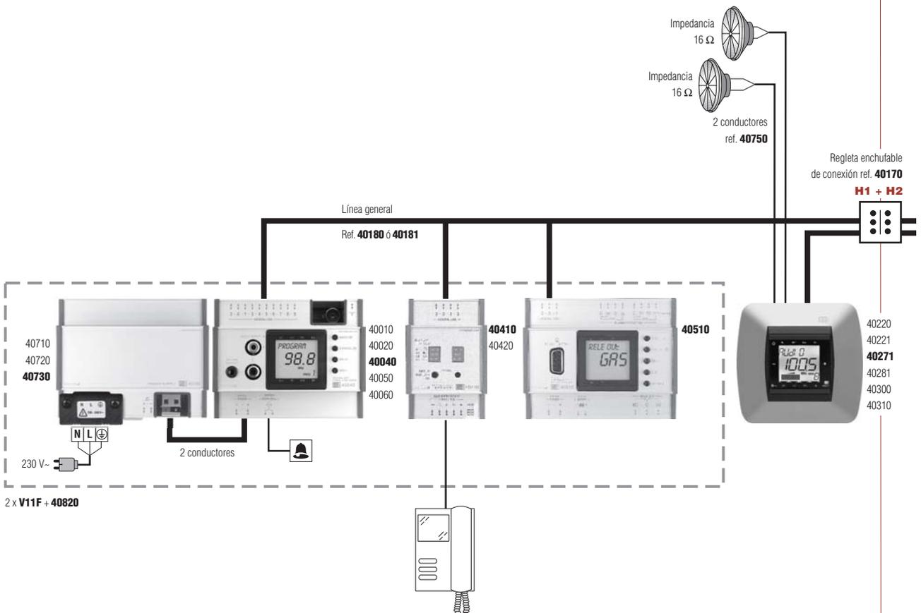
El portero automático puede responderse desde cualquier punto de la instalación a través del módulo 40410. Los mandos de control son las referencias 40271 y 40281 (con sintonizador local FM) empotrados en caja de  $\varnothing 60$  mm.
