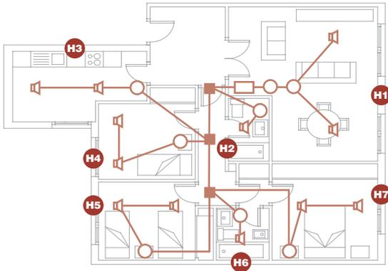
La instalación que se presenta a continuación, proporciona un sistema de audio estéreo de alta calidad, con unidad de reloj e intercomunicación\* para toda la instalación. Está compuesta por elementos básicos de la serie DOMOS2.
