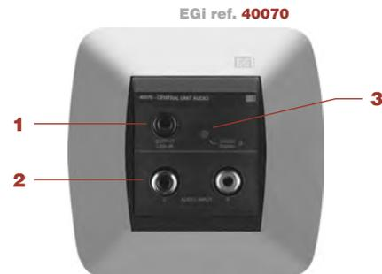
Para conectar su equipo de audio a la instalación, utilice un cable de conexión referencia **EGi** ref. **0502** si su fuente posee una conexión RCA o **EGi** ref. **0501** si la salida del equipo de sonido a conectar es de tipo jack 3,5 mm. Suba progresivamente el volumen de la fuente hasta que vea parpadear el LED de presencia de audio.
