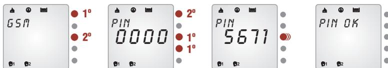
Pasados unos segundos, leerá en la pantalla un mensaje de confirmación **PIN OK** o un mensaje de error. Si en el mensaje de error aparece un **1**, indica que el PIN introducido es incorrecto. Compruebe el PIN. Si en el mensaje aparece un **2**, indica que se ha superado el tiempo permitido para procesar su petición. Intente el proceso de nuevo. Si el problema se repite, contacte con su instalador.
