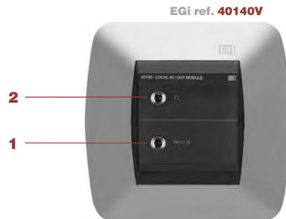
El módulo **EGi ref. 40140V**, proporciona una entrada de audio estéreo (**1**) a través de un conector tipo jack 3,5 mm. Puede conectar cualquier tipo de fuente musical a esta entrada, a través del cable **EGi ref. 0501** ó **0503**. El modelo también dispone de una salida para auriculares estéreo (**2**).
