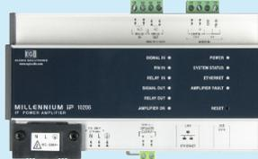
Amplificateurs de puissance audio IP en format Rack 2U.
